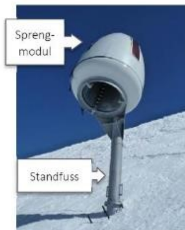
Abb. 12 O'BellX Anlage im Feld
